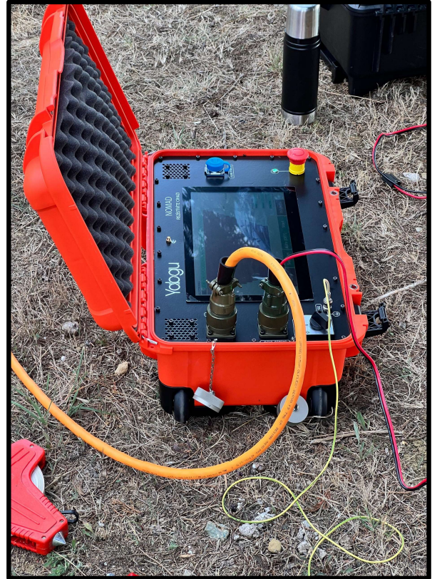
Görsel 4 – ERT Cihazımızın Arazideki Görüntüsü
