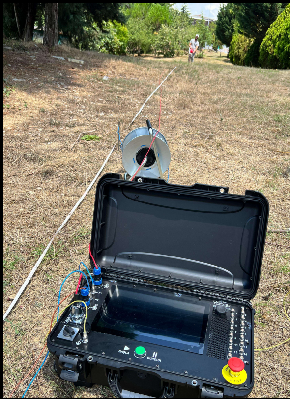
Görsel 3 – DES Cihazımızın Arazideki Görüntüsü
